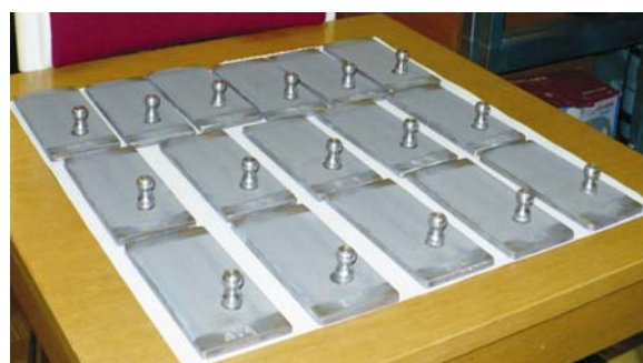
3 pav. Priklijuoti Dolly bandiniai
