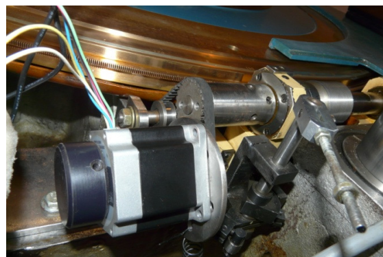
6 pav. Žingsninis variklis su slietine pavara ir papildoma diržine pavara
